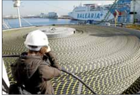
Bobina de cable en el buque que hará el tendido.
